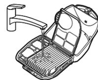
ダストケースの部品は、すべて水洗いできます (旋回部は、はずして水洗いし、乾燥させる)
